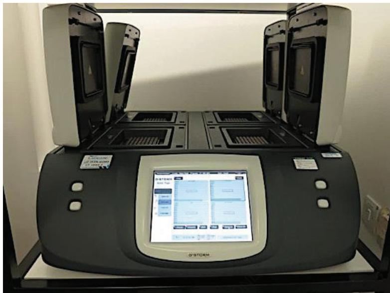
**Figura (45):** Tipicamente, a PCR consiste numa série de 20-40 mudanças de temperatura repetidas chamadas ciclos térmicos.
