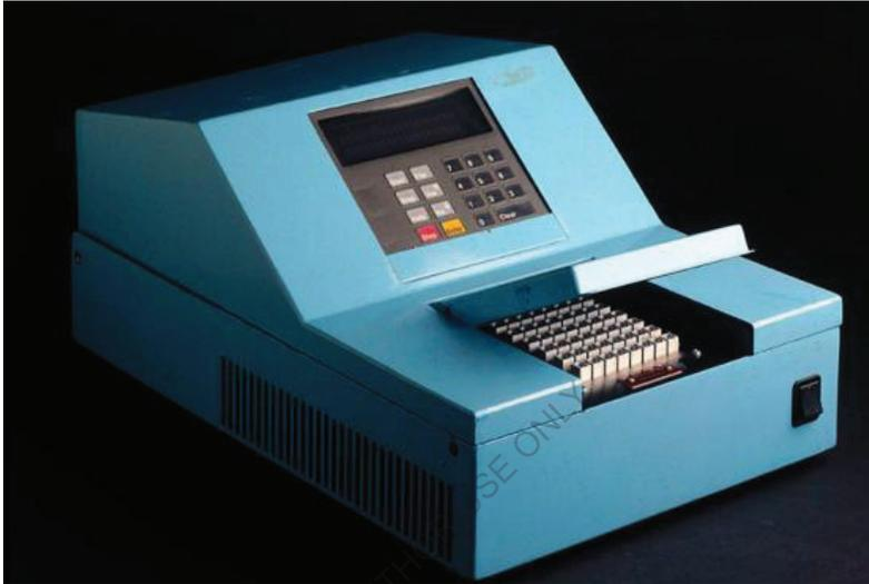
**Figura (50):** Processo baseado em termociclador para amplificação de ADN.
