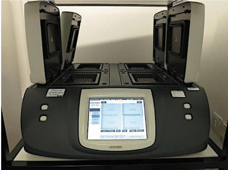
**Figure (45) : En général, la PCR consiste en une série de 20 à 40 changements de température répétés, appelés cycles thermiques.**
