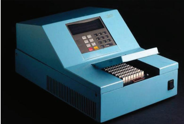
**Figure (50) : Processus d'amplification de l'ADN basé sur un thermocycleur.**
