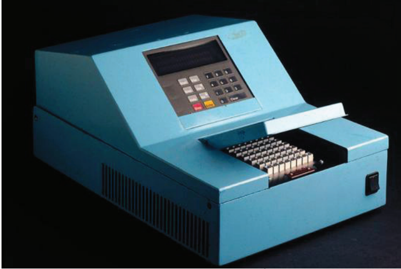
Abbildung (50): Thermocycler-basiertes Verfahren zur DNA-Amplifikation.
