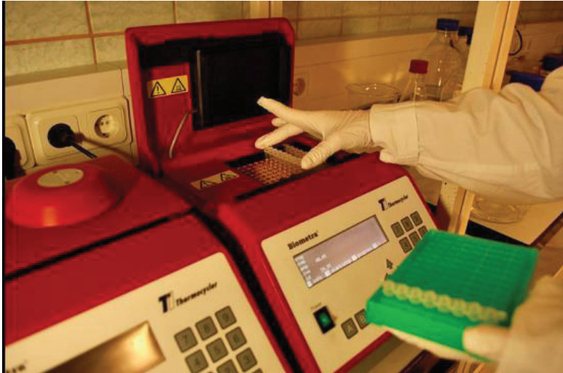
Abbildung (44): Die PCR amplifiziert einen bestimmten Bereich eines DNA-Strangs.
