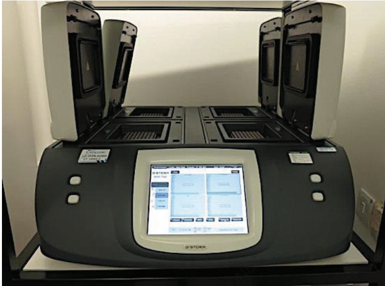
Abbildung (45): In der Regel besteht die PCR aus einer Reihe von 20-40 wiederholten Temperaturwechseln, den so genannten thermischen Zyklen.
